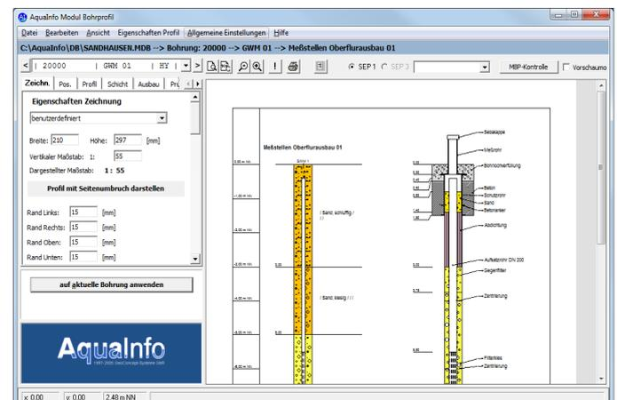
Modul Geologie: Dieses Modul ermöglicht die Darstellung und Verwaltung von geologischen Schicht- und Ausbaudaten.
